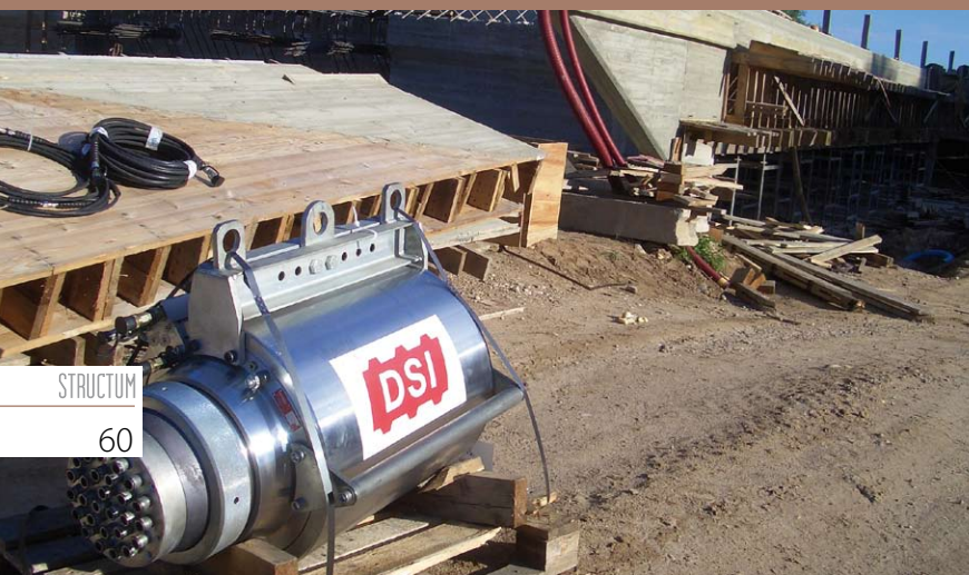
▼ Tiltas per Persės upę perdanga buvo armuota 19-os ir net 27-ų lynų pluoštais, todėl jiems įtempti prireikė naudoti beveik 1 200 kg sveriančią hidraulinę įtempimo įrangą.
